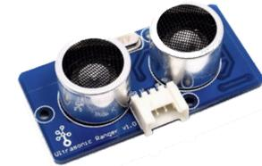
Este sensor sirve para medir la **distancia** entre el sensor y un objeto.
